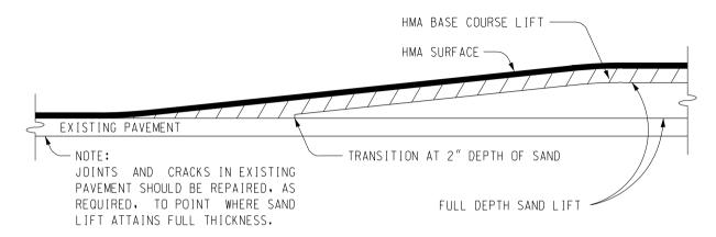
LENGTH OF TRANSITION TO BE ADJUSTED TO SECURE GOOD VERTICAL ALIGNMENT.
